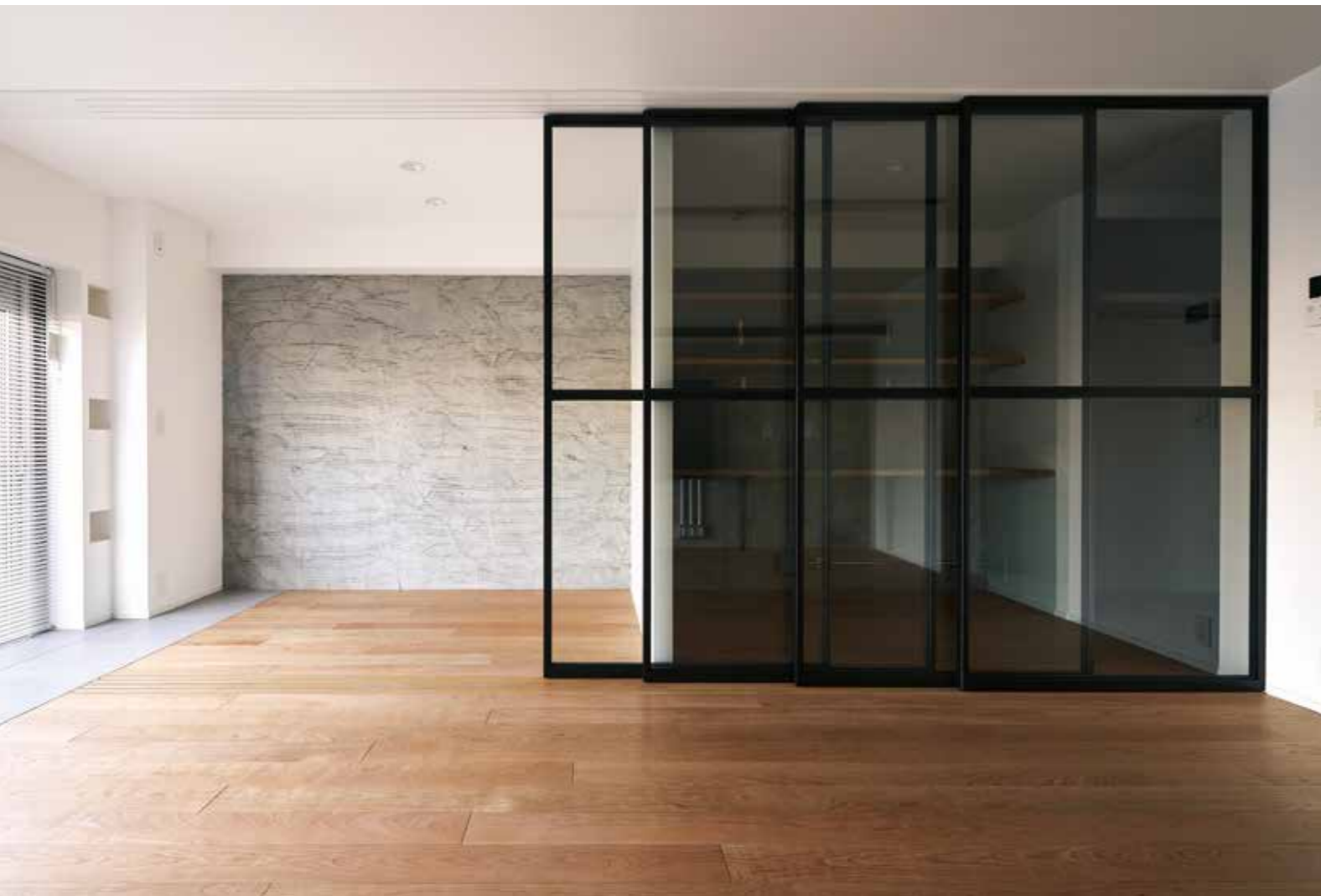
複合(挽板)一枚もの(床暖房兼用)ナチュラル【オスモ自然塗装】12×130×1818 AC90S 向坂建築設計事務所
