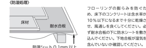
フローリングの膨らみを防ぐため、床下のコンクリートは含水率が10%以下になるまで十分に乾燥させ、風通しを良くしてください。必ず耐水合板の下に防水シートを敷き込んでください。下地合板が湿気を含んでいないか確認してください。
